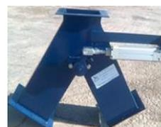
**By Pass com comando pneumático**
