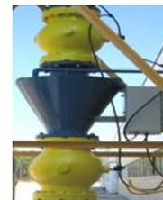
**Válvula de descarga Dosapro**
